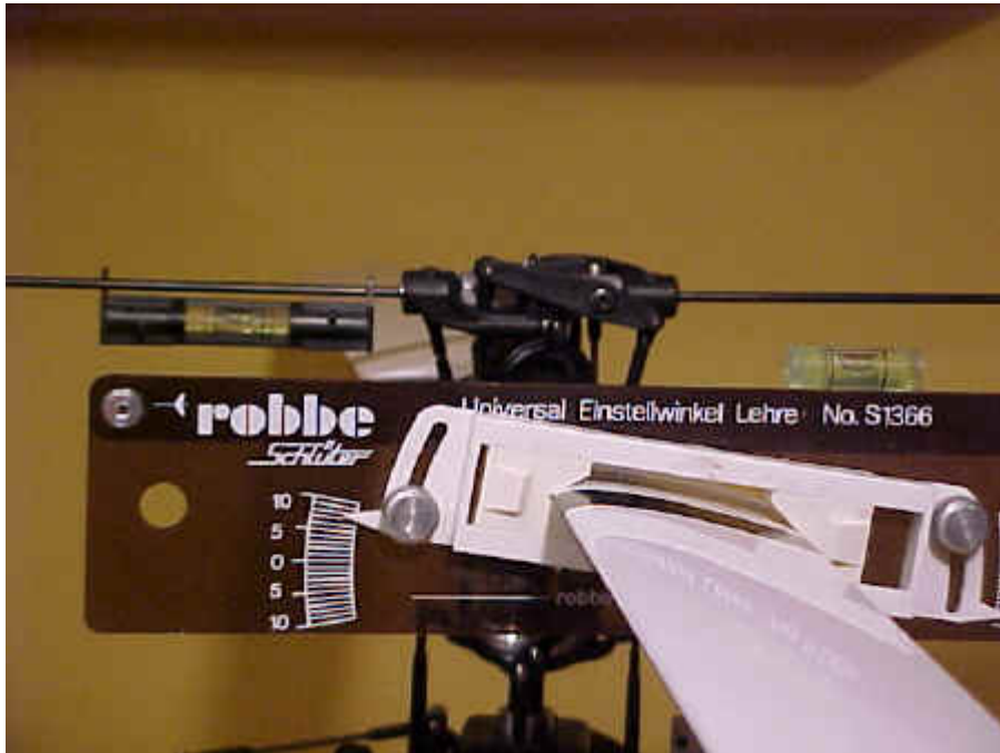
(FOTO 12) (que se vea paralelo el eje de las estabilizadoras con la parte superior del medidor de ángulos), el ángulo que marque el medidor será el que tengan las palas
